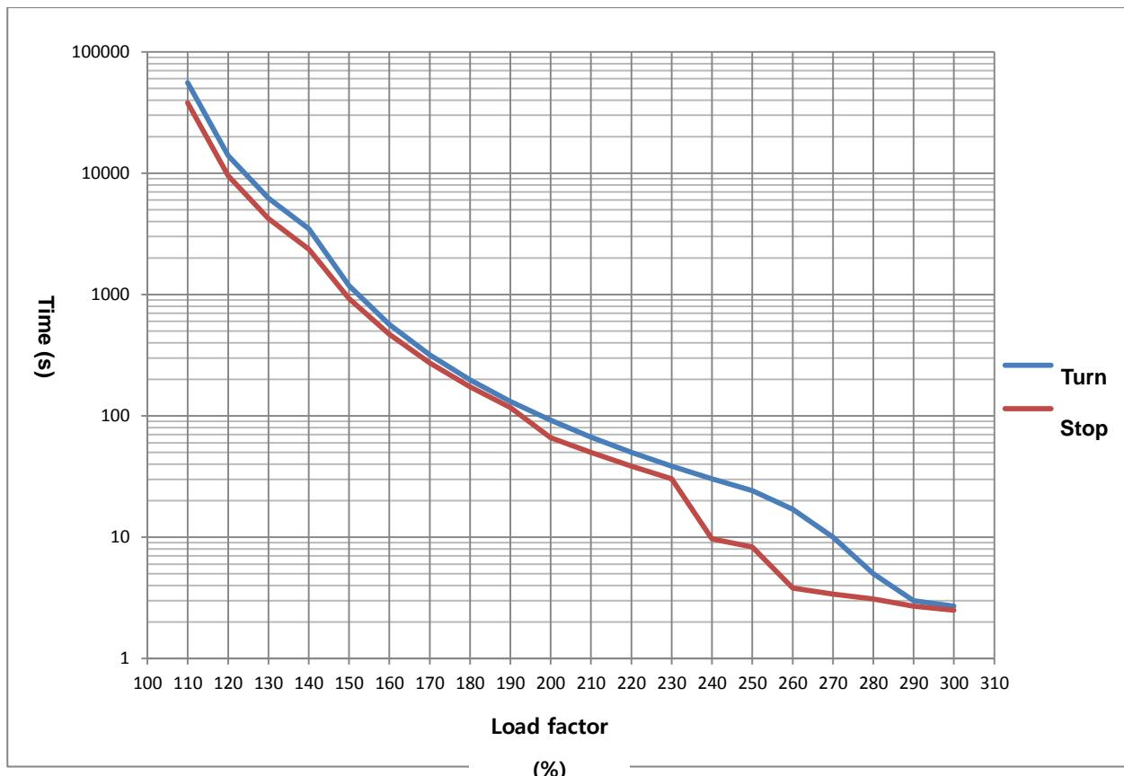
■ Servo Drive Overload Graph (750W, 1kW)
